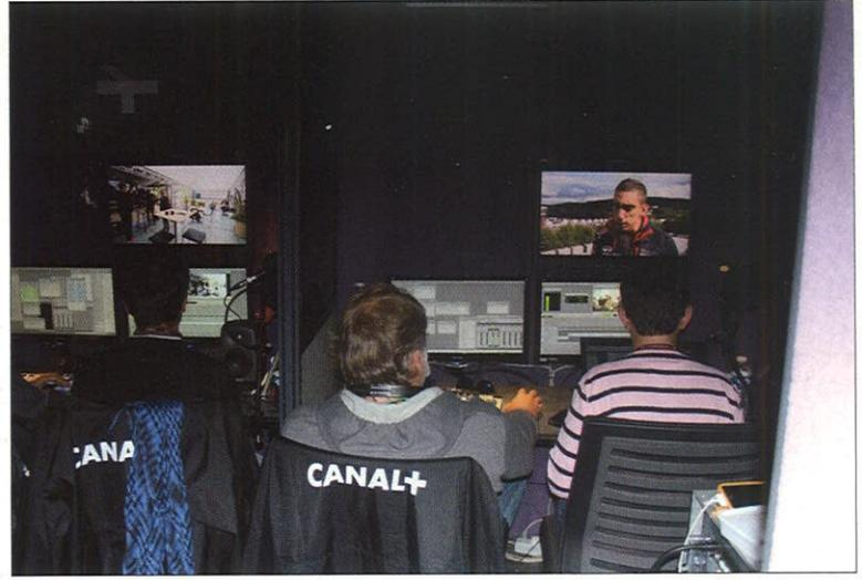
Dans le car Extender 2, seule la salle de montage est un peu isolée du reste des autres postes. Deux stations Media Composer sont exploitées ainsi qu'un portable pour l'ingest et le dérushage. Le logiciel After Effects est, lui, utilisé pour l'étalonnage.
